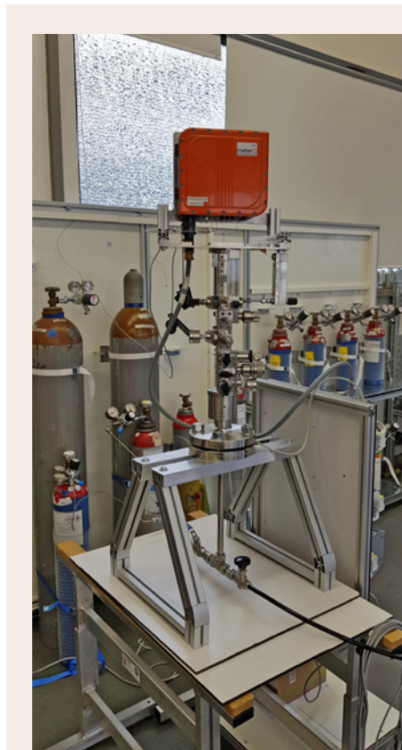
Bild 2: Aufbau des 1. Prototypen eines PGC-Transmitters
