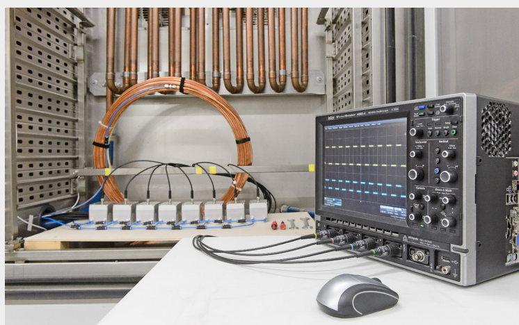
Bild 4: Kalibrierung von mehreren Gasbeschaffenheitssensoren [6]
