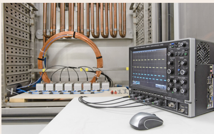
Bild 4: Kalibrierung von mehreren Gasbeschaffenheitssensoren vom Typ gasQS der Firma MEMS AG [6]
